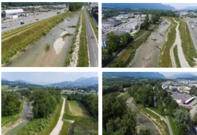
Después, junio de 2019: trabajos sobre la morfodinámica del lecho del río, instalación de vegetación, retirada del dique y reintegración del bosque aluvial en el espacio entre el dique, instalación de módulos (fajonas, deflectores etc. para crear diversificación y devolver la vegetación al curso de agua, etc.). Desde junio de 2019, la vegetación se ha desarrollado, como se ve sobre el terreno, el aspecto del entorno sigue siendo diferente al que podríamos ver en 2019.
